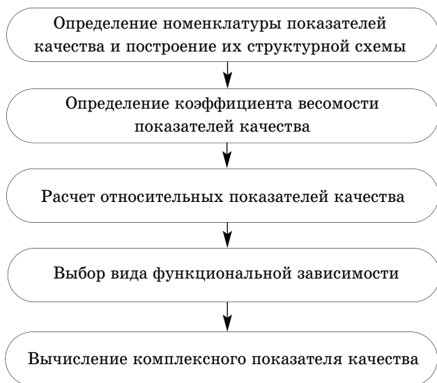
Рис. 2.5. Алгоритм расчета комплексного показателя качества
